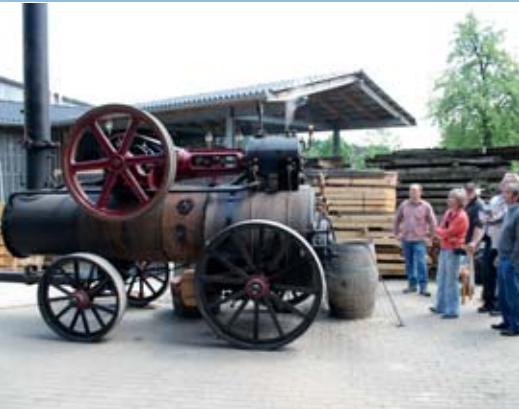
Na bitte, geht doch! Bei zehn Bar bläst das Überdruckventil unter kräftigem Zischen ab.
